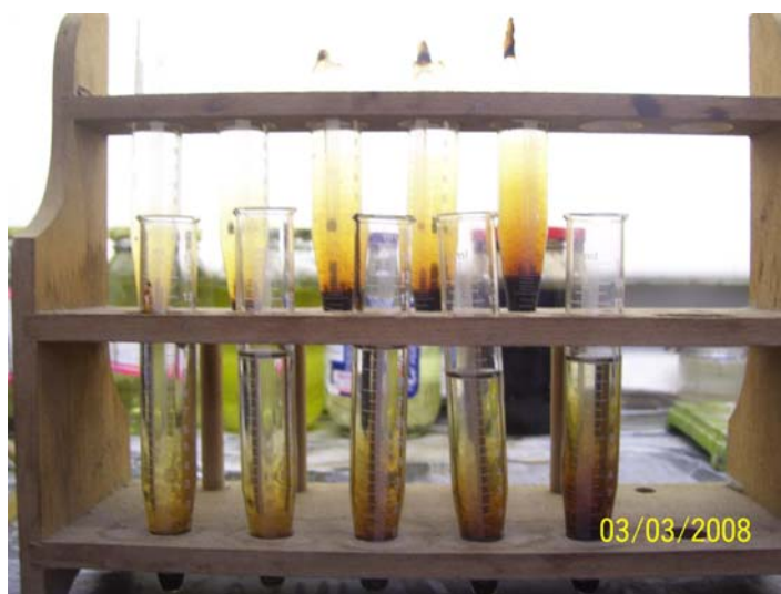
Figura 18. Tubos de centrifuga con la prueba de dispersión de asfaltenos.
