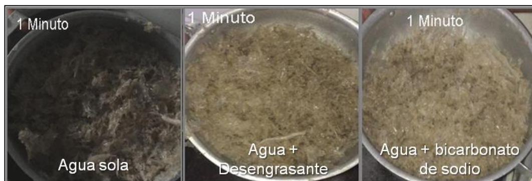
Figura 4.1. Resultado de lavado de plástico con las diferentes mezclas de detergente durante 1 minuto.
