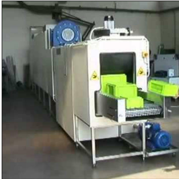
Figura 4.5. Sistema de lavado de plástico a través de agua a presión (Crisanto 2002).
