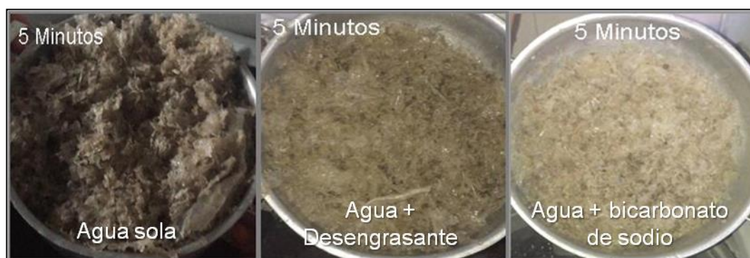
Figura 4.3. Resultado de lavado de plástico con las diferentes mezclas de detergente durante 5 minutos.
