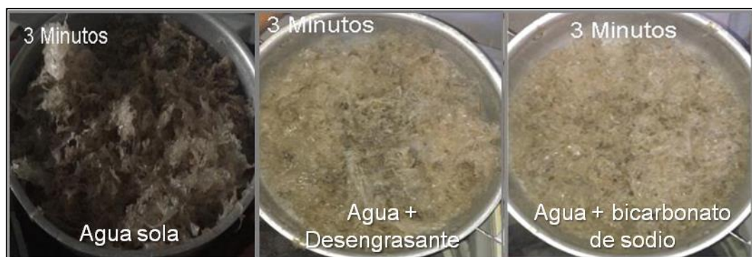
Figura 4.2. Resultado de lavado de plástico con las diferentes mezclas de detergente durante 3 minutos.
