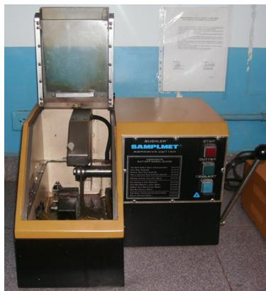
**Figura 3.9 Cortadora Metalográfica.**
