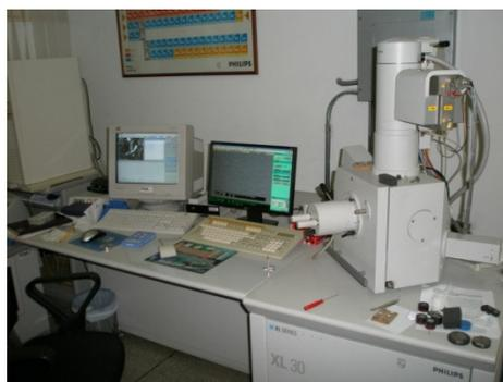
**Figura 3.18 Microscopio Electrónico de Barrido en FUNDATEC.**
