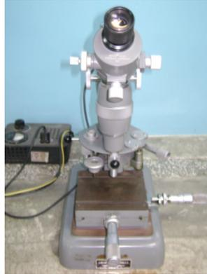
Figura 3.16 Microdurometro
