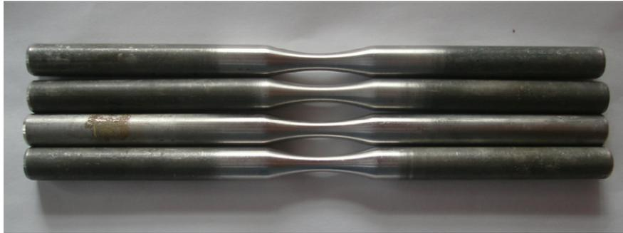
Figura 4.15. Probetas de AA-6061 Utilizadas para los Ensayos de Fatiga.
