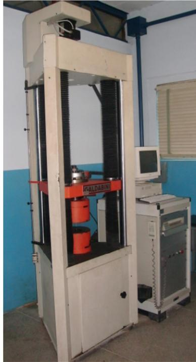
*Figura 3.15 Máquina Universal de Ensayos a Tracción CMT 20 Galdabini*
