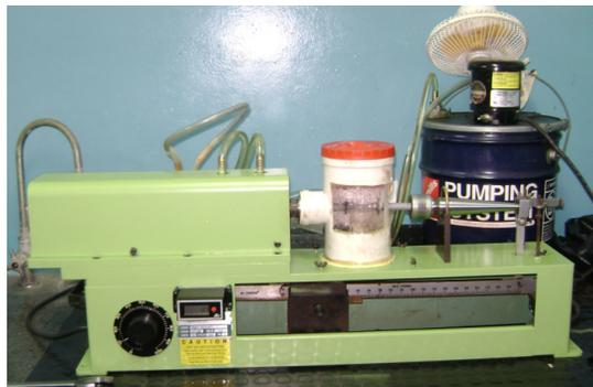
Figura 3.13 Máquina de Ensayo de Fatiga a flexión rotativa RBF – 200.
