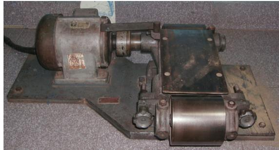
*Figura 3.10 Lijadora de Banda.*
