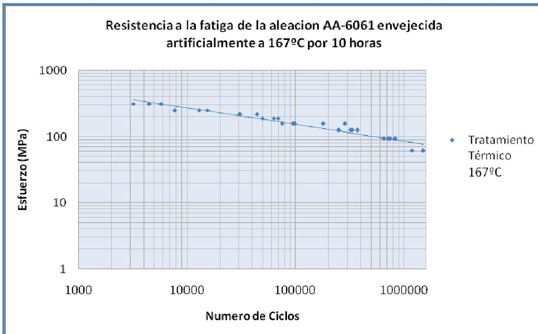
**Figura 4.17** Curva Lineal izada de la Resistencia a la Fatiga del AA-6061 Envejecida Artificialmente a 167°C por 10 horas y Sometido a un Medio Corrosivo de NaCl al 3%.
