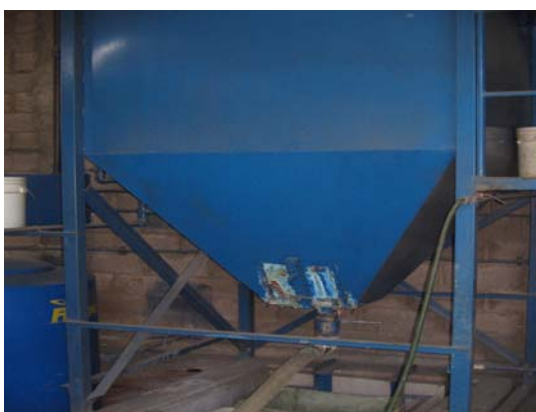
Figura 6.3 Unidad de sedimentación utilizada en el proceso de electrocoagulación
