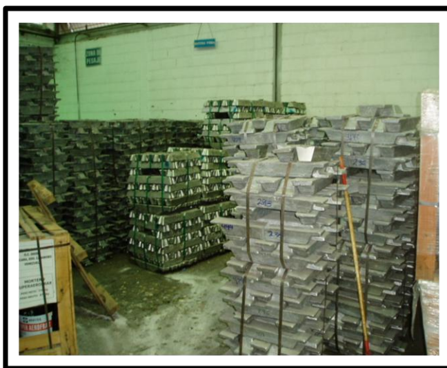
Figura 2.17. Bulto de lingotes de materia prima, aleación de aluminio F-132.
