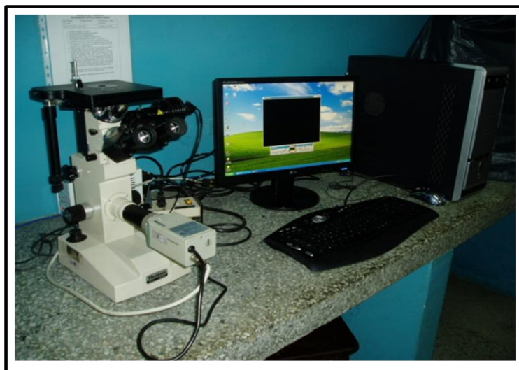
Figura 3.11. Microscopio óptico para estudio de la superficie atacada de la probeta.
