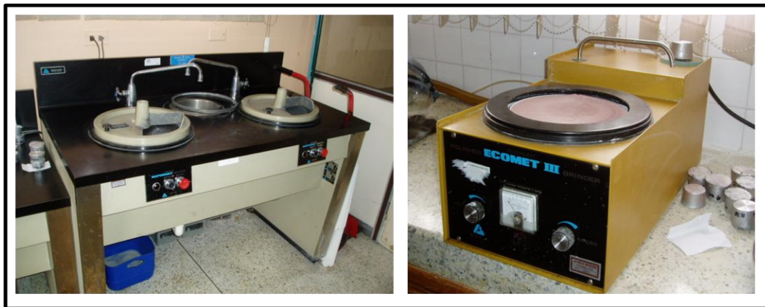
Figura 3.9. Pulidora de lijas de grano (izquierda), pulidora de paño (derecha).
