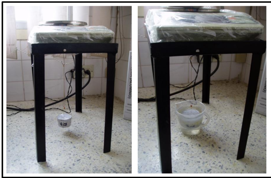
Figura 3.7. Peso de la probeta al aire (izquierda), peso de la probeta sumergido en agua (derecha).
