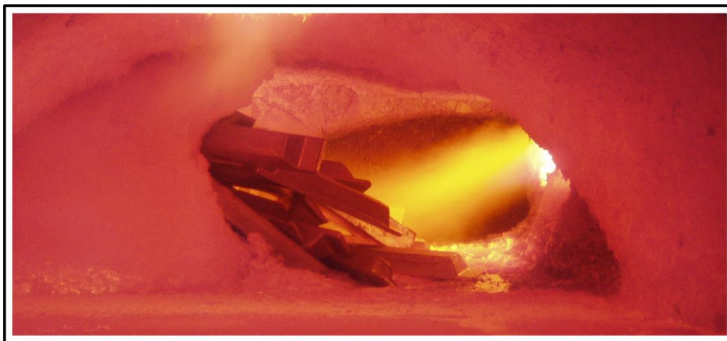
Figura 4.32. Incidencia de la llama sobre la carga a fundir en el horno Guinea.
