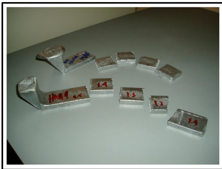
Figura 4.33. Probetas obtenidas por el molde “K”.
