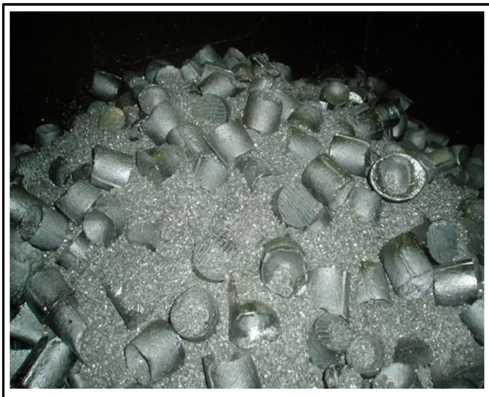
Figura 4.27. Mazarotas como material de retorno.
