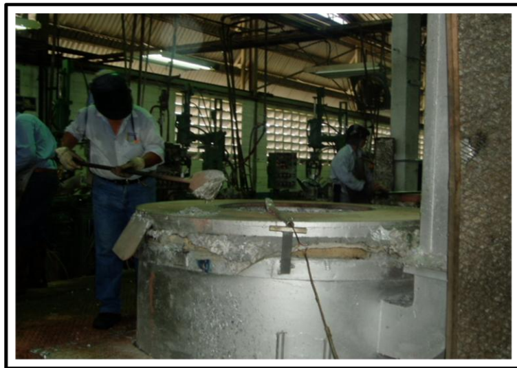
Figura 2.22. Limpieza de la escoria del horno de retención.
