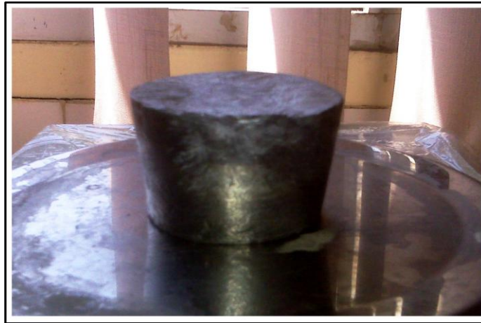
Figura 3.5. Probetas obtenidas mediante el crisol.
