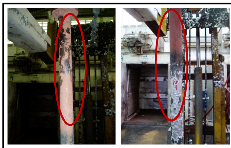
Figura 4.9. Prueba de eje de acero nuevo (izquierda), eje de acero después de tres pruebas (derecha).
