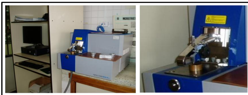
Figura 3.8. Espectrómetro (izquierda), punto de colocación de las probetas en el espectrómetro (derecha).
