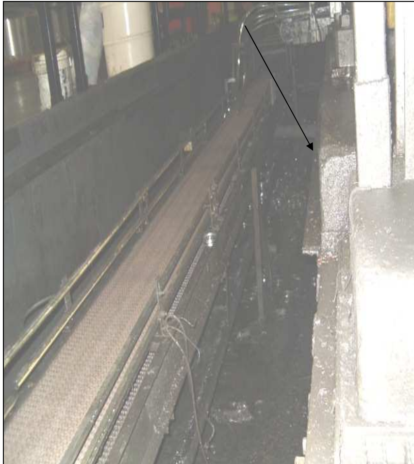
Figura N° 3. Fosa en la cual se acumula mucha suciedad y desperdicio del proceso. Fuente: Superenvases Envalic.
