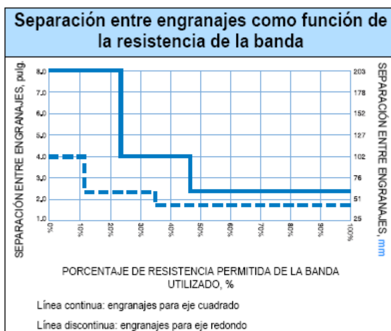
Anexo N° 14. Separación entre engranajes. Fuente: Catálogo INTRALOX.
