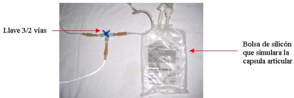
Figura 6.8. Llave 3/2 vías para permitir el flujo de la solución salina.
