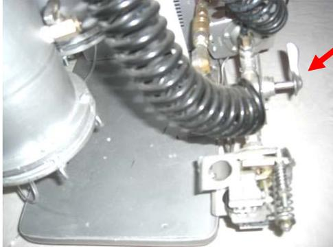
Figura 6.9. Llave 2 pasos para darle dirección al flujo de fluido a las Cámaras de Compresión
