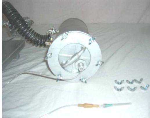
Figura 6.5. Cámara de Compresión sellada después de introducir la bolsa de solución
