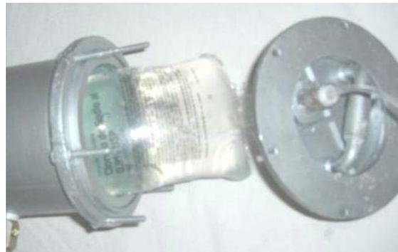
Figura 6.3. Tapa desconectada de la Cámara de compresión
