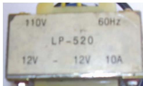
Figura 5.12 Especificaciones del transformador (Ferretería EPA, 2008)
