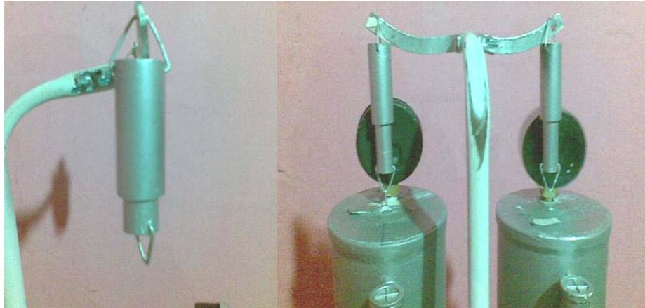
Figuras 5.19. Cámaras con las bolsas de solución ausentes o completamente vacías.
