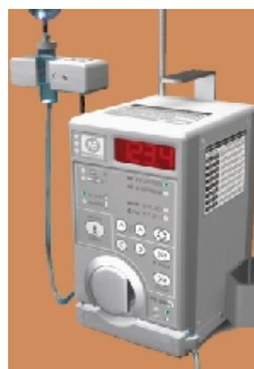
Figura 2.6. Bomba peristáltica NB400B
