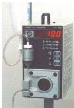
Figura 2.3. Bomba peristáltica NB100
