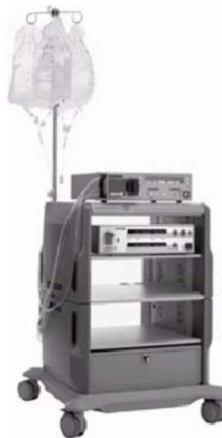
Figura 1.4. Sistema de bombeo peristáltico controlado electrónicamente. (Wojnarowski y Mora, 2006)
