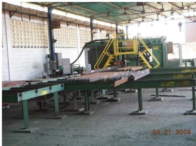
**Figura 4.4.** Bancada de salida. (TRIME, C.A)
