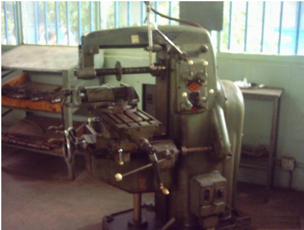
**Figura 2.1 Máquina fresadora horizontal**
