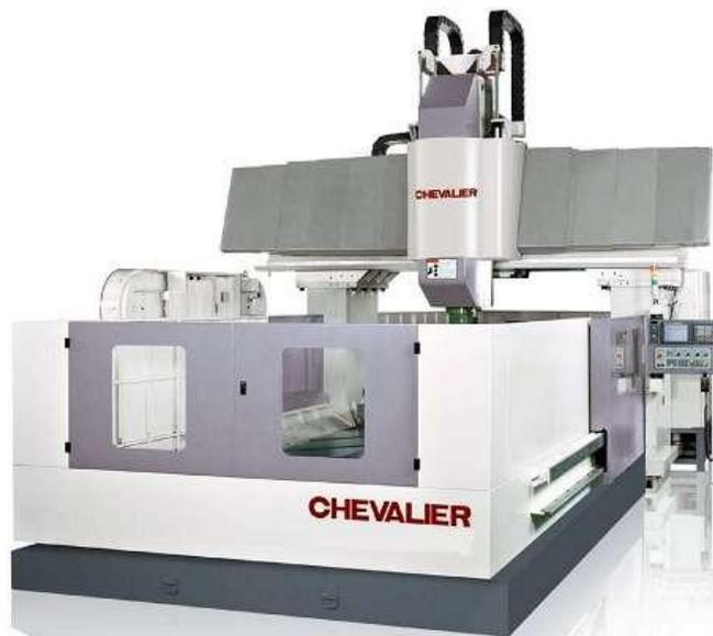
**Figura 2.6 Máquina Fresadora de Pórtico**
