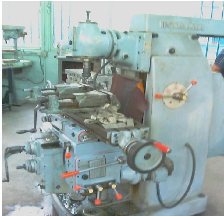
**Figura 3.2** Máquina fresadora universal con cabezal vertical marca INDUMA
