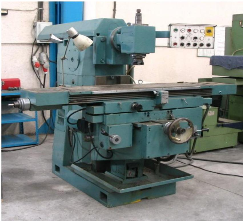
**Figura 2.3 Máquina fresadora universal**
