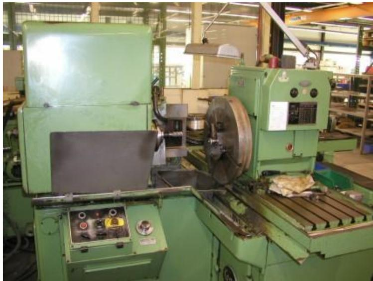
**Figura 2.4 Máquina fresadora circular**
