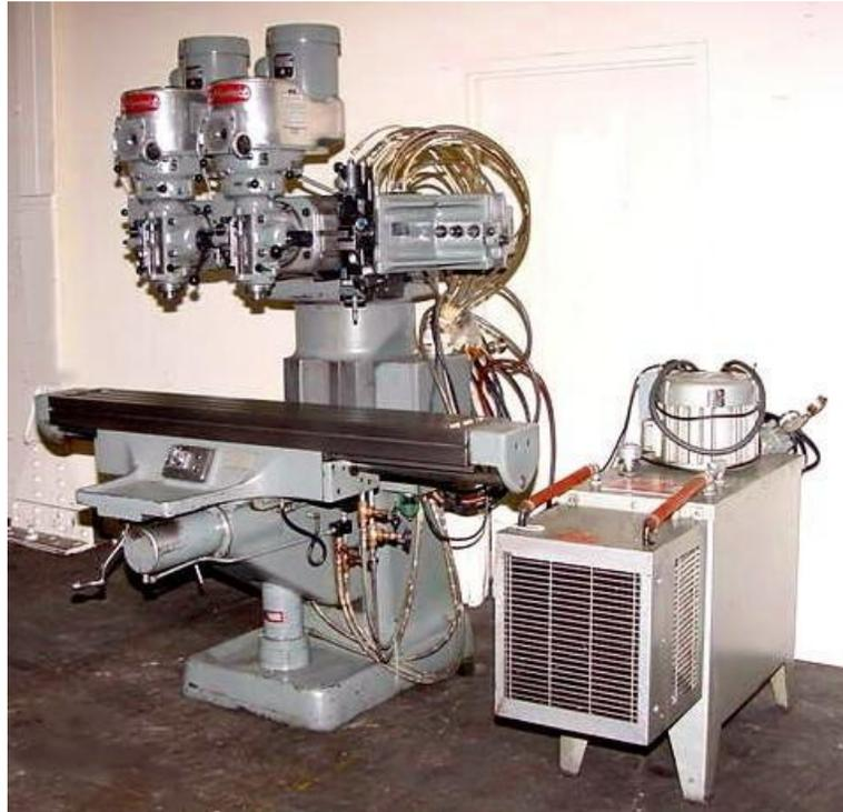
**Figura 2.5 Máquina Fresadora Copiadora**
