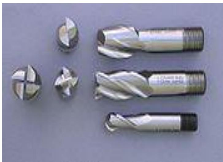
**Figura 3.3** Fresas de vástagos de acero rápido
