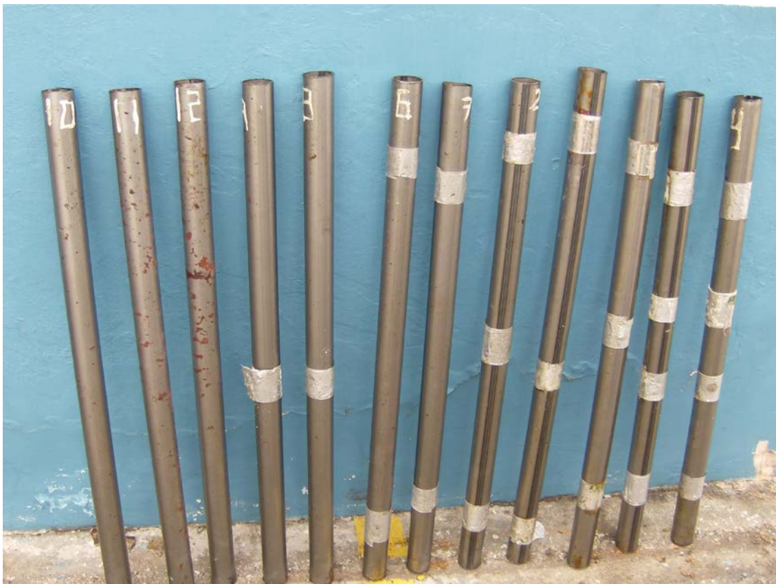
Figura 4.18 Tubos después de 20 días con y sin cinta de aluminio.
