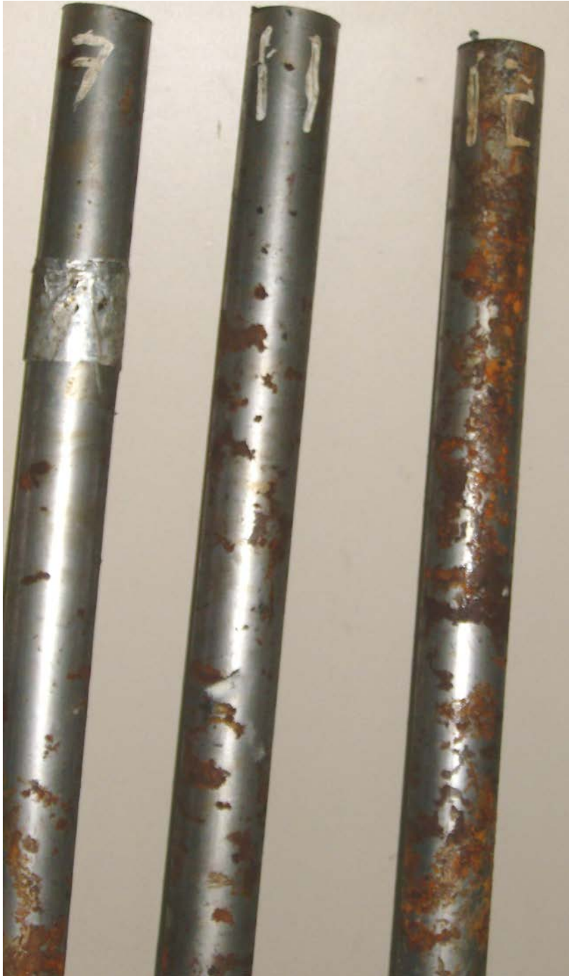
Figura 4.22 Deterioro de los tubos 7,11 y 12 transcurrido 47 días
