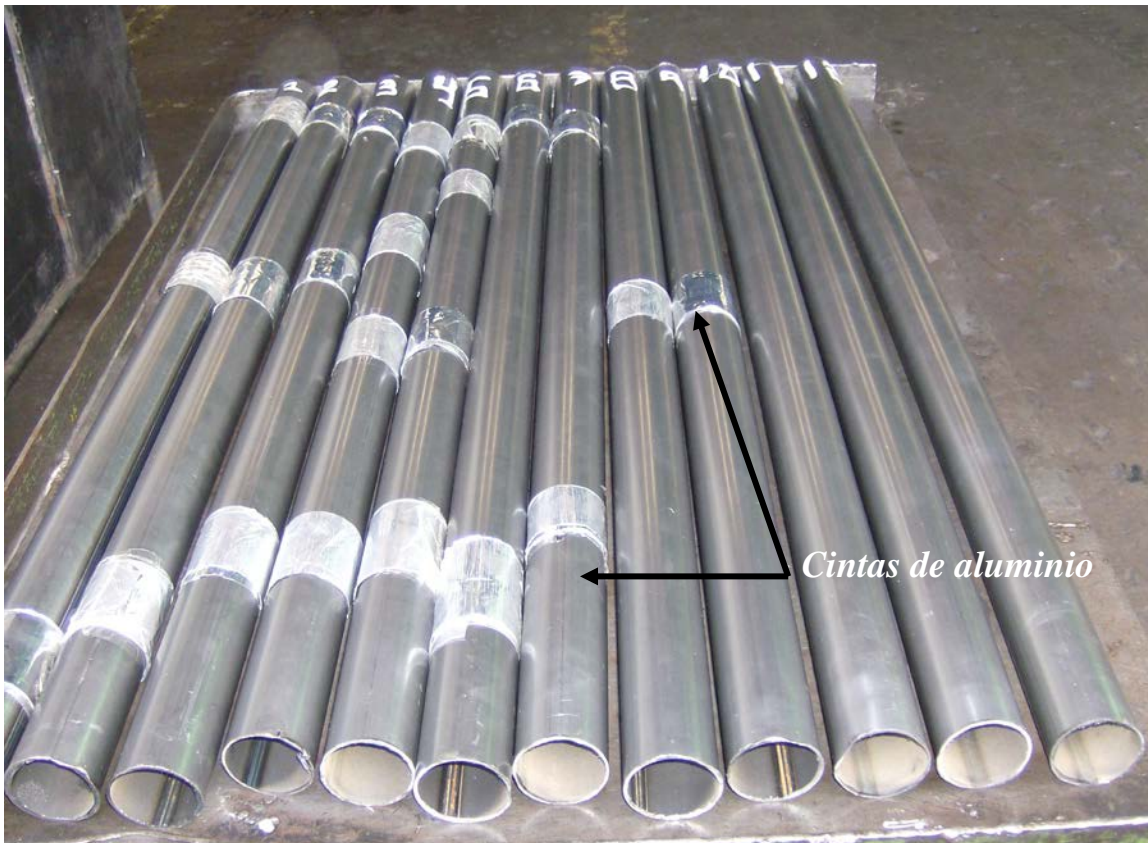
Figura 4.17 Tubos con diferentes cantidades de cintas de aluminio.
