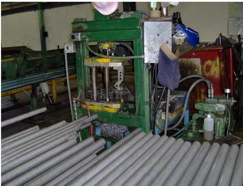
Figura C.2 Cortadora de puntas de los tubos luego de trefilar
