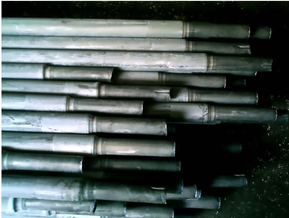
Figura C.3 Tubos fosfatizados con punta para el trefilado
