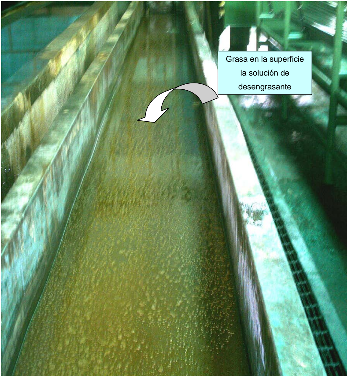
Figura 4.23 Cuba de desengrasado con exceso de grasa en la parte superior de la solución.
