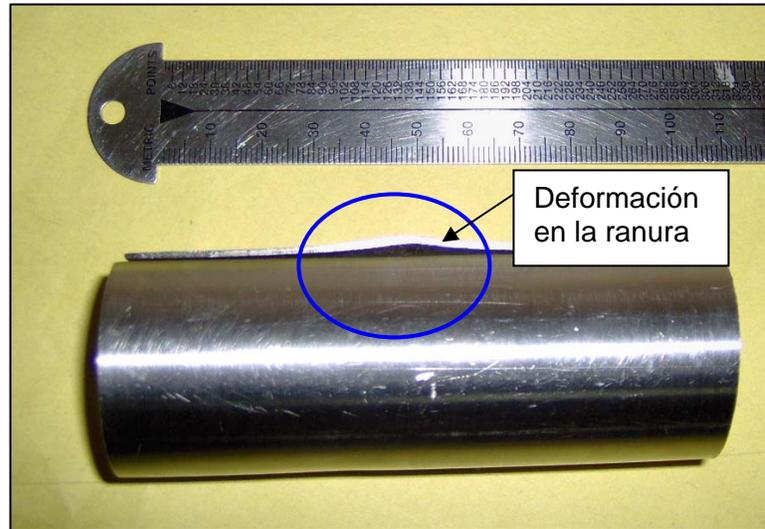
Figura no AII.1 Daño de la Carcasa
