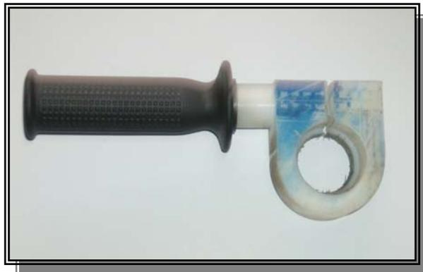
Figura No AIV.6. **Brida de sujeción del tubo con el taladro**
