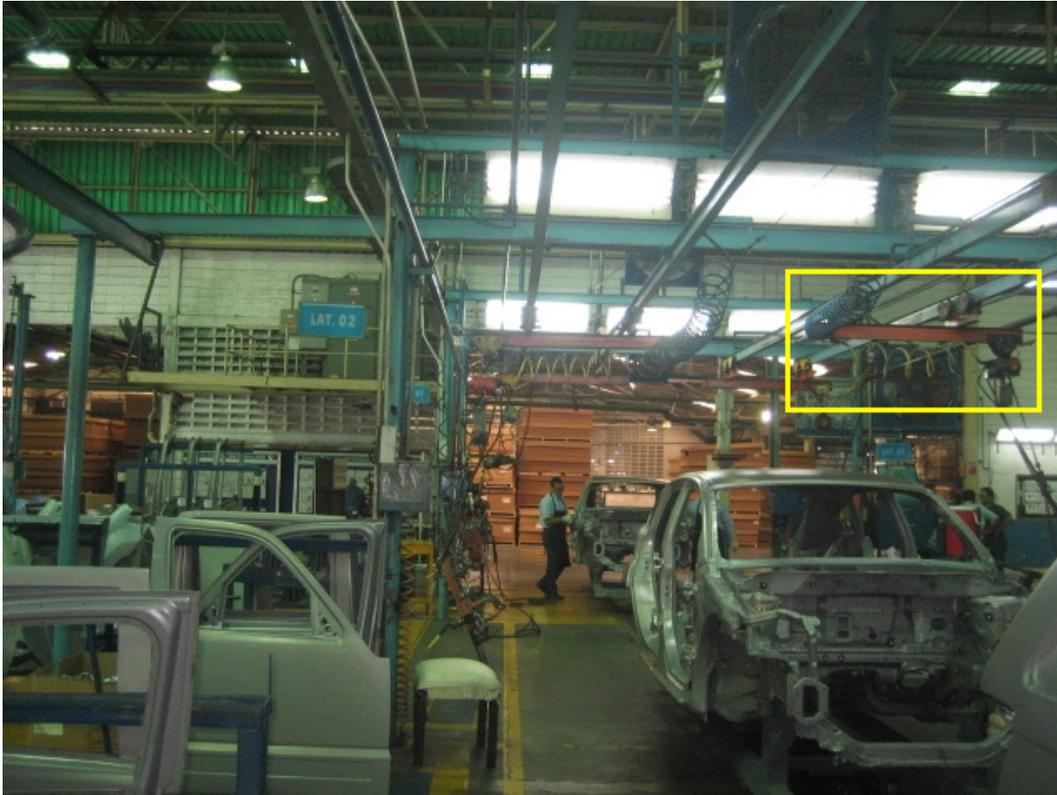
Figura 4.2.4: Detalle del porta grúas en la estación 2 del área de latonería.
