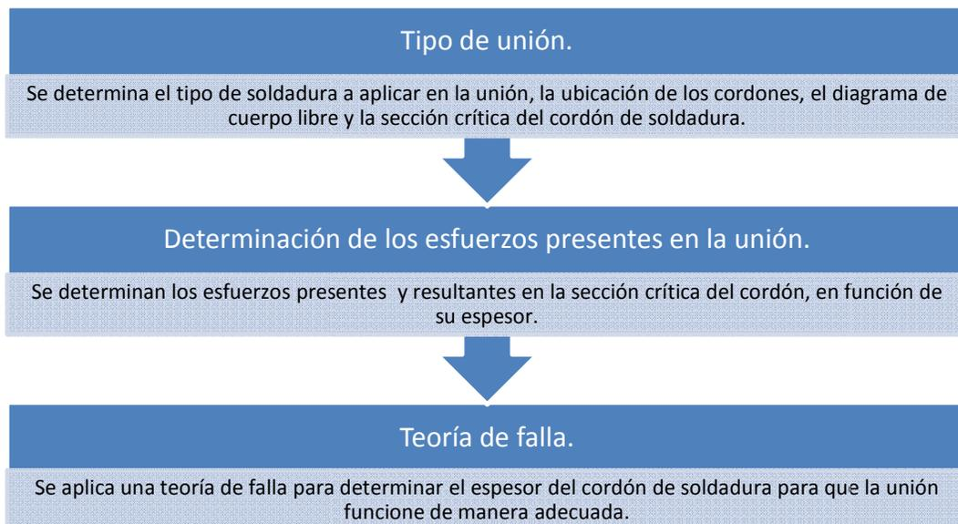
Figura 4.4.2.1: Procedimiento para el cálculo de las uniones soldadas de los elementos que conforman el brazo mecánico.
