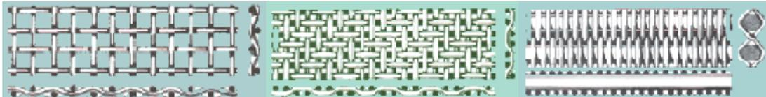
Figura 2.8 Distintos tipos de mallas para el medio filtrante
