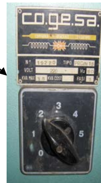
Figura III.6. Máquina de soldadura por resistencia eléctrica (Electropunto). Modelo Cogesa Voltaje 220V 60Hz Kv Máx 15.
