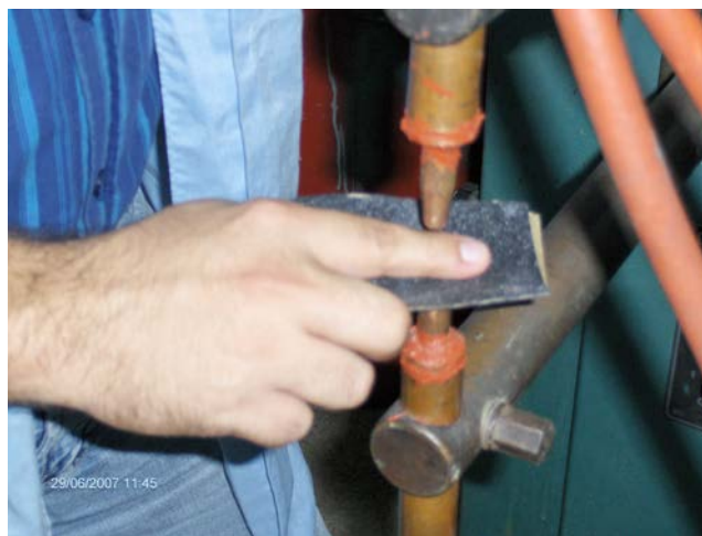
Fig. IV.9 limpieza de adherencia de bronce en la cara de los electrodos. Fuente propia.
