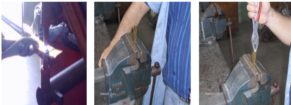
Fig. IV.1. Ensayo piloto y prueba destructiva (PEEL). Fuente propia.
