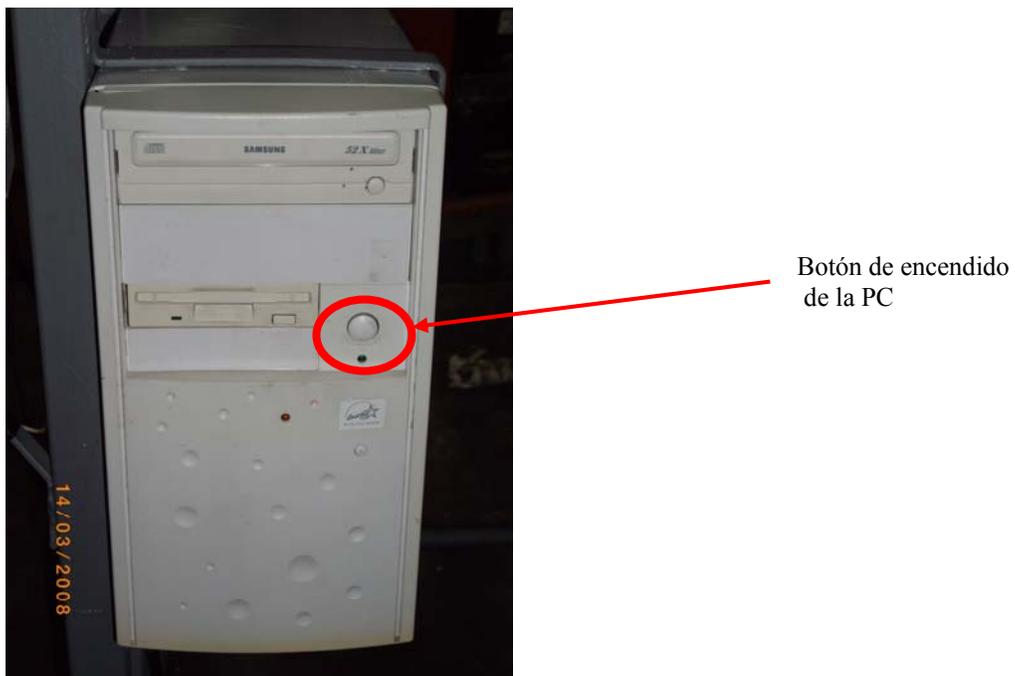
Figura 4.24. Botón de encendido del computador
