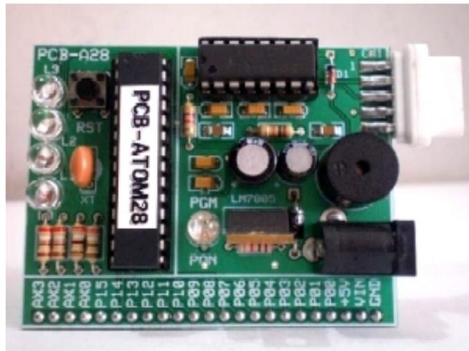
Figura 4.15 Microprocesador PIC .
