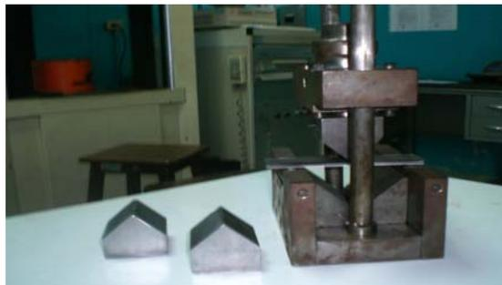
FIGURA 3.4. Herramientales usados en el ensayo de doblado en “V”
