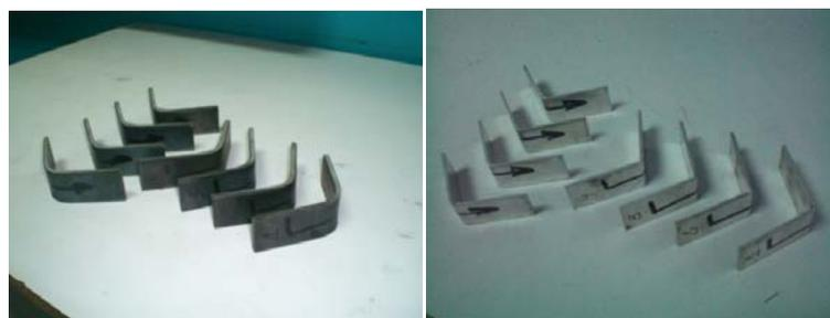
**FIGURA 3.14** Probetas después del Ensayo de Doblado. (a) Acero ASTM A-36 (b) Aluminio 3003 H-14 3mm
