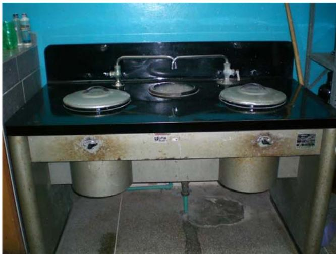
**Figura 3.15.** Banco de pulido usado para análisis metalográfico.
