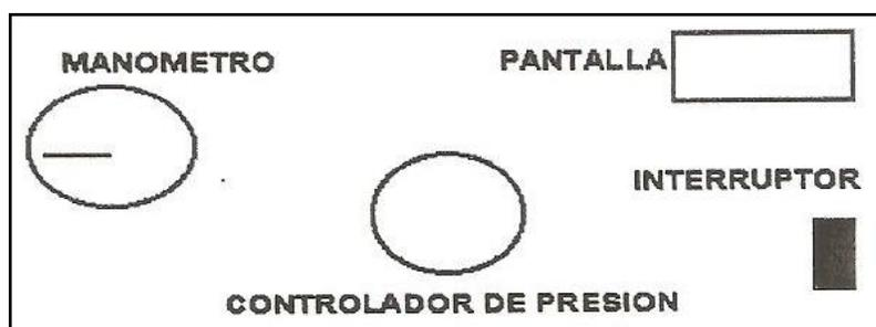
Figura C.4. Esquema de la parte frontal del módulo de la bomba.
