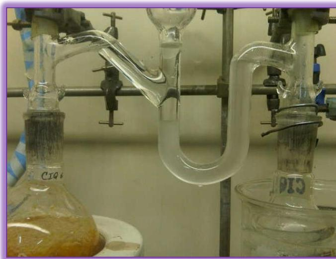
**FIGURA 4.2. RECOLECCIÓN DE LOS COMPONENTES VOLÁTILES EN LA INTERFASE**
