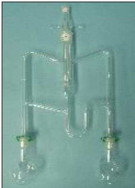
**FIGURA 2.5. EQUIPO DE EXTRACCIÓN-DESTILACIÓN SIMULTÁNEA (LIKENS Y NICKERSON, 1964). (Guadayol, 1994).**
