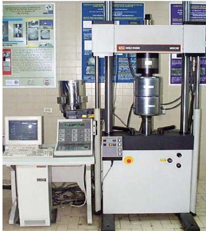
**Fig.3.8** Equipo utilizado en los ensayos de tracción.
