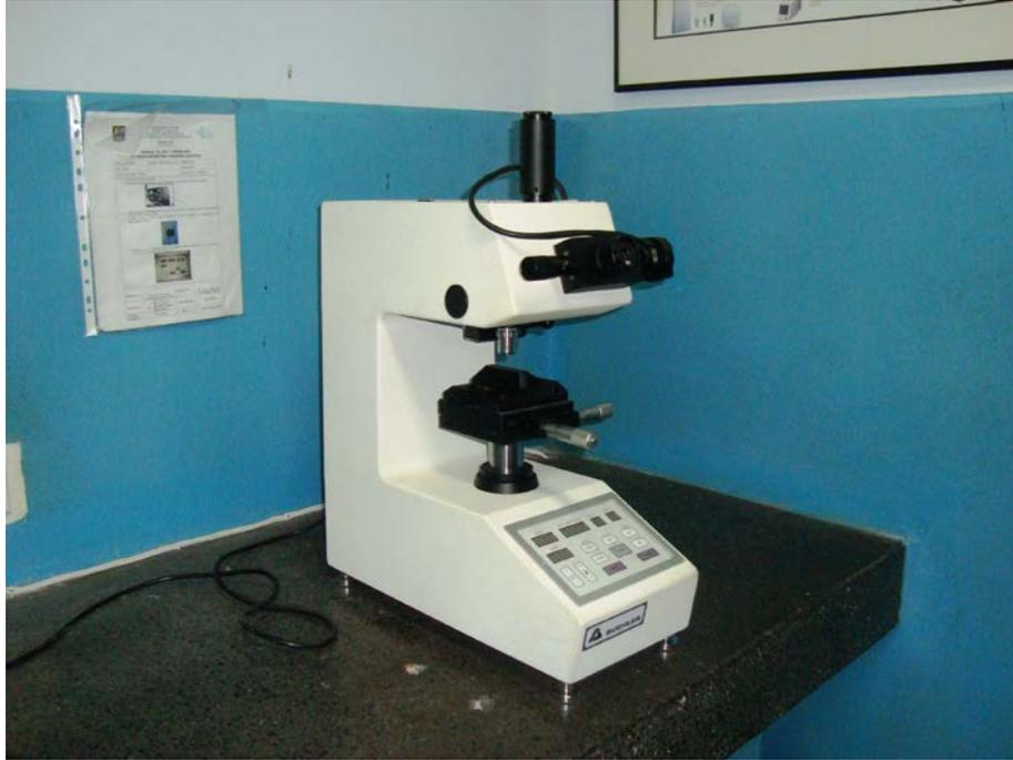
**Fig. 3.4 Microdurómetro Indentamet 1100**
