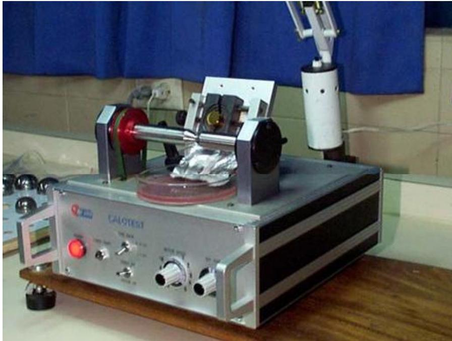
**Fig. 3.5 Equipo Utilizado para Determinar el Espesor de los Recubrimientos Mediante la Técnica de la Calota Esférica (Calotest)**
