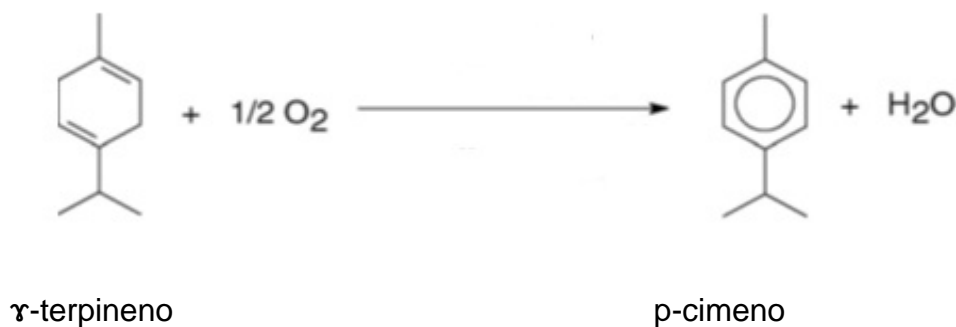
FIGURA 4.3 MECANISMO DE CONVERSIÓN DE \gamma -TERPINENO A P-CIMENO
