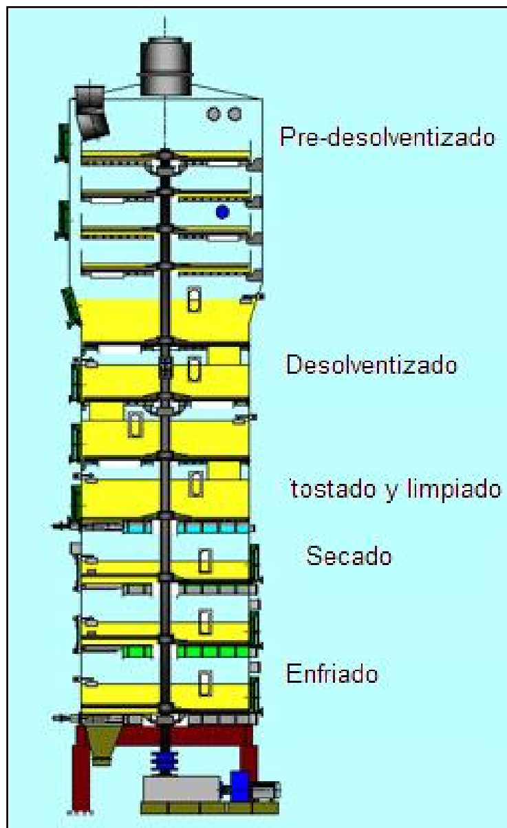
Figura 3.7. Desolventizador / tostador de SMET (DT)
