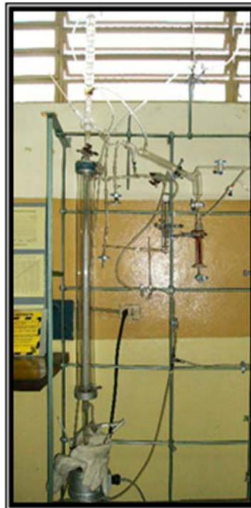
**Figura 3.3 Equipo de destilación empleado**
