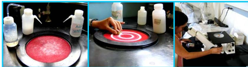
Figura 3.5. A. Paño en el disco de pulido. B. Pulido de probeta.
