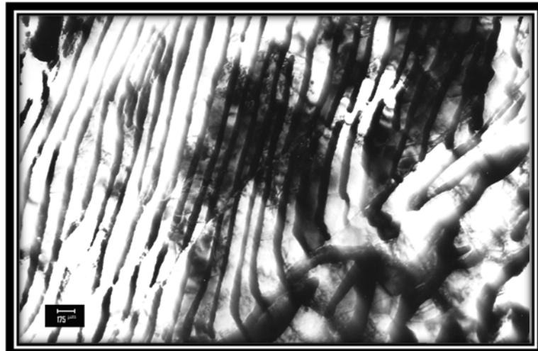
Figura 4.8 Micrografía en campo claro de un acero 1080 con propiedad de relajación normal a 85500X.
