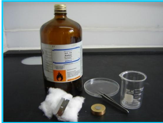
Figura 3.14 Materiales para el cambio de lado de la muestra
