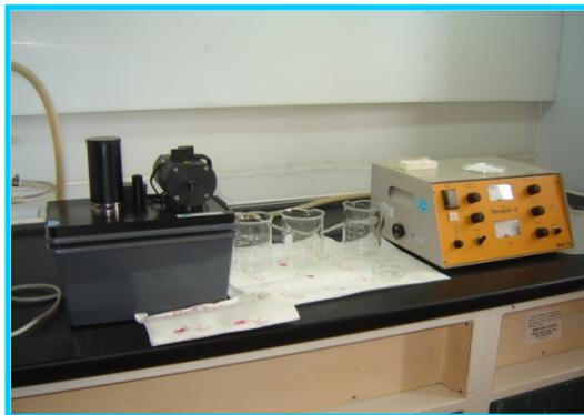
Figura 3.17 Máquina de electropulido
