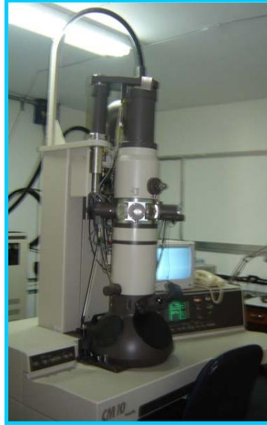
Figura 3.20 Microscopio Electrónico de Transmisión
