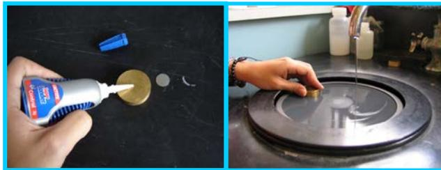
Figura 3.3. A. Fijación de la probeta y el dispositivo de agarre. B. Lijado de la probeta en el disco de pulido.
