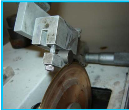
Figura 3.2. Corte de la probeta con disco abrasivo
