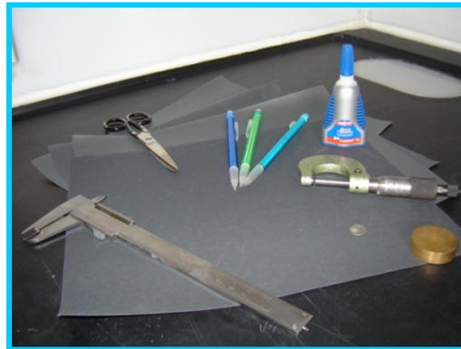
Figura 3.12 Materiales para el adelgazamiento con lijas
