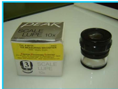
Figura 3.19. Lupa con escala
