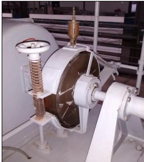
Figura 2.9. Freno Prony de la turbina Pelton del Laboratorio de Hidráulica UC.
