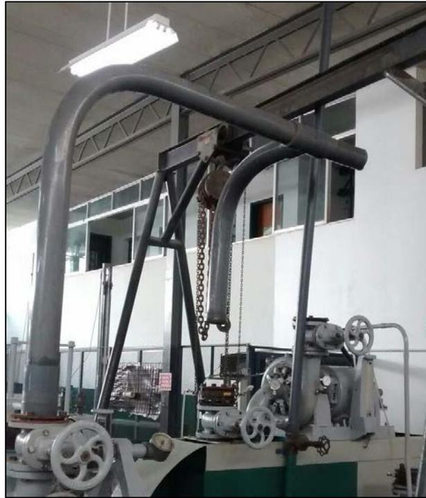
Figura 4.18. Manifold original del sistema de turbina Francis y turbina Pelton del Laboratorio de Hidráulica, Universidad de Carabobo fracturado.
