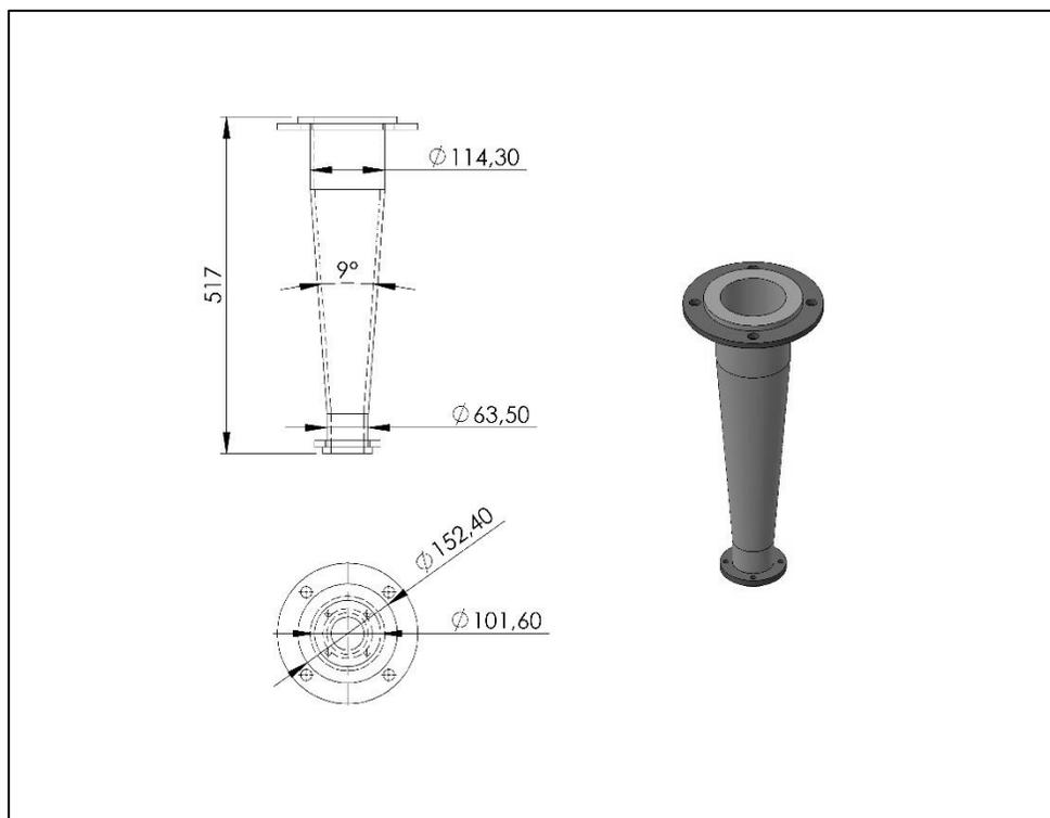
Apéndice A.4. Descarga cónica del sistema de turbinas del Laboratorio de Hidráulica.
