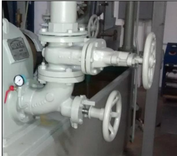
Figura 2.8. Sistema de turbina Pelton, Laboratorio de Hidráulica UC. Mecanismo de regulación de caudal.
