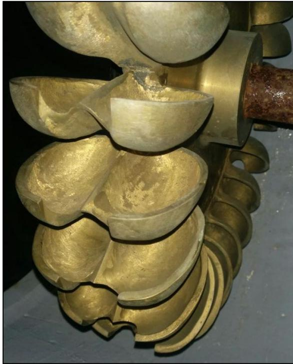
Figura 2.5. Álaves de la turbina Pelton del Laboratorio de Hidráulica UC.
