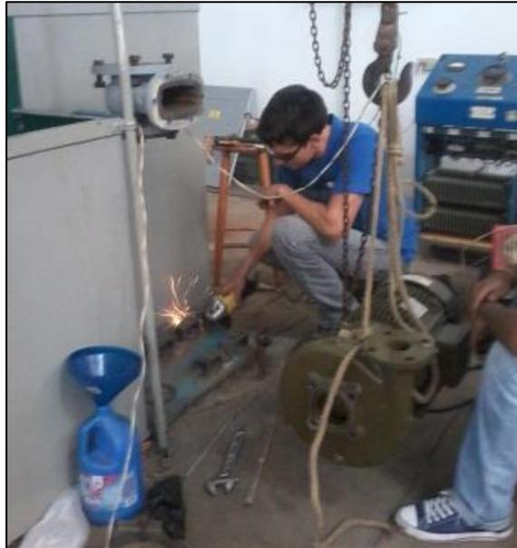
Figura 4.34. Fabricación de soportes metálicos inferiores de la bomba centrífuga del sistema de turbina Francis y turbina Pelton del Laboratorio de Hidráulica, Universidad de Carabobo.
