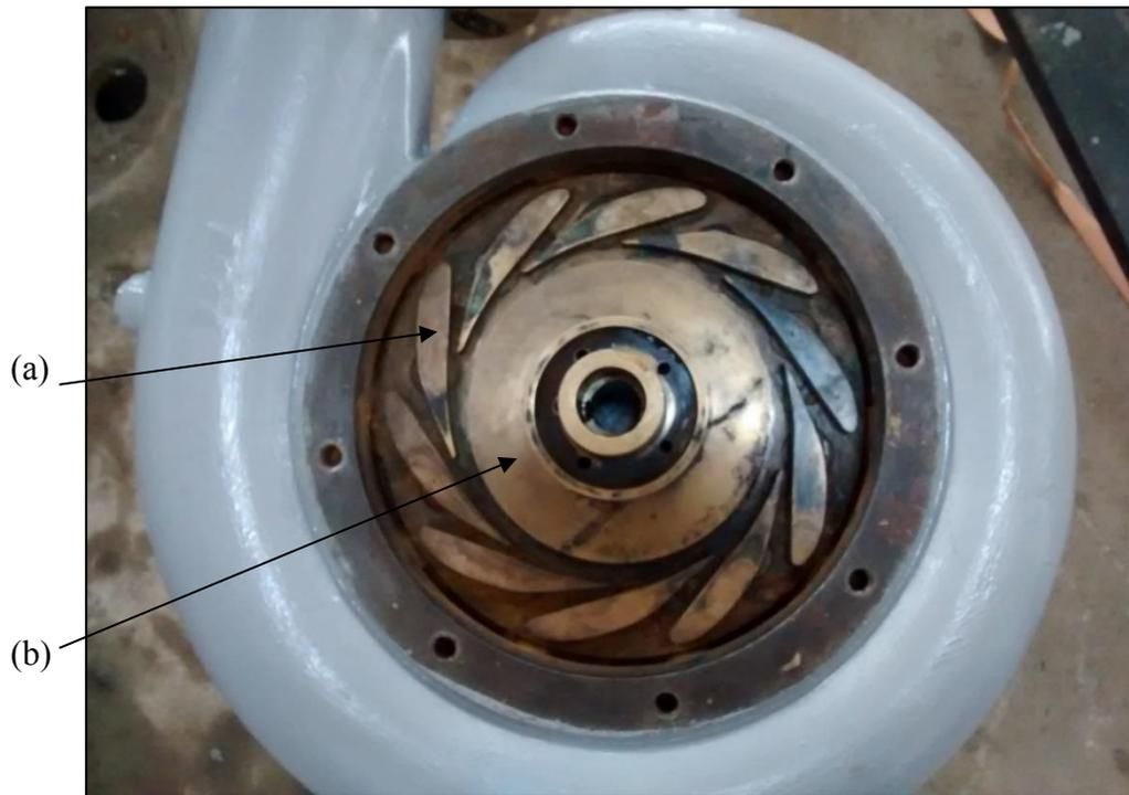
Figura 2.11. (a) Álabes del distribuidor. (b) Rodete de la turbina.
