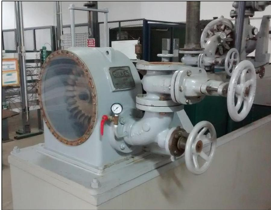
Figura 2.3. Sistema de turbina Pelton del Laboratorio de Hidráulica UC.
