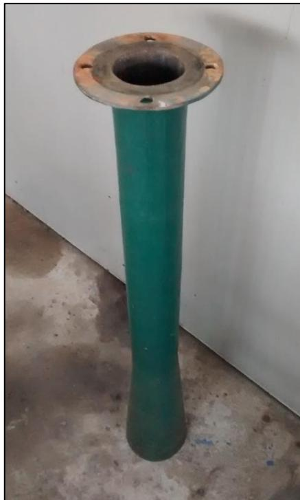
Figura 2.14. Tubo de aspiración de la turbina Francis del Laboratorio de Hidráulica UC.
