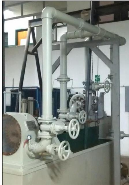
Figura 4.46. Manifold de distribución en acero galvanizado instalado en el sistema de turbina Francis y Turbina Pelton del Laboratorio de Hidráulica, Universidad de Carabobo.
