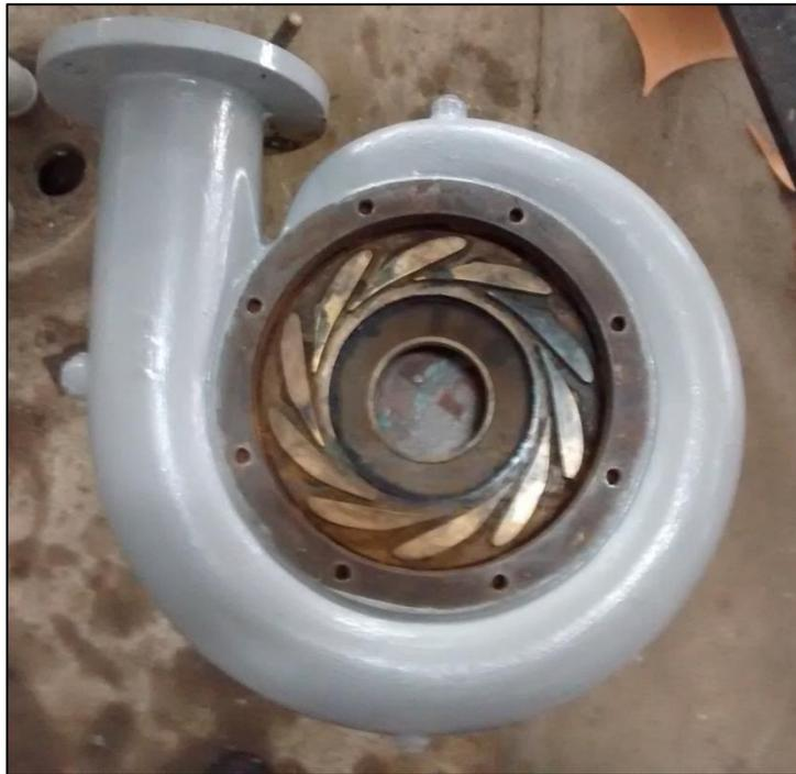
Figura 2.10. Cámara espiral de la turbina Francis del Laboratorio de Hidráulica UC.
