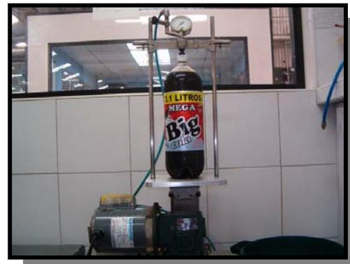
**Figura 3.7. Medidor de presión de CO<sub>2</sub> (Fuente: Propia)**
