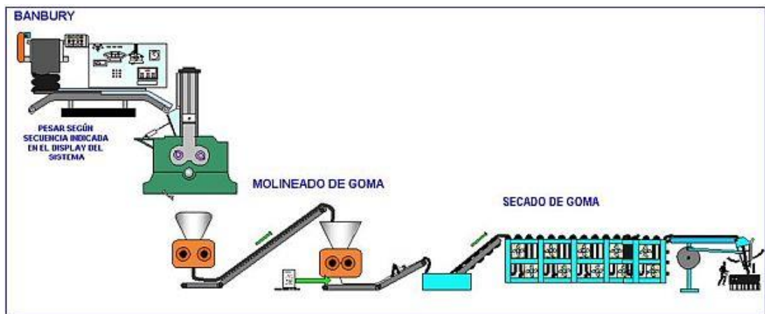
Figura 10. Proceso de mezcla de compuestos de goma
