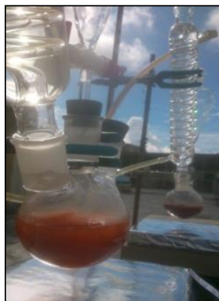
Figura 4.2 Montaje experimental para la degradación de fenol utilizando lodo rojo-CVG-Bauxilum
