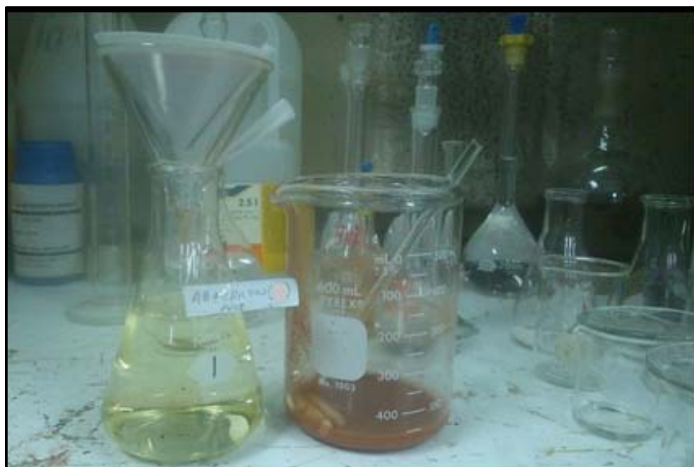
Figura 7.3 Agua agria tratada por el proceso de oxidación avanzada utilizando radiación solar y lodo rojo como catalizador.
