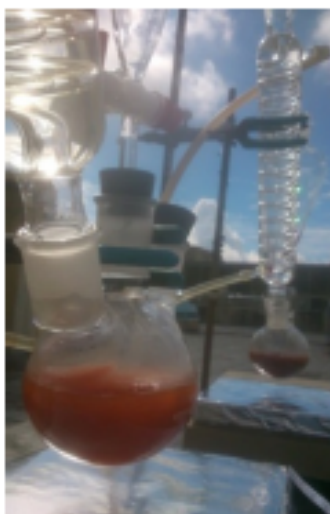
Fig.1: Configuración del montaje experimental para el estudio del proceso de oxidación avanzada utilizando radiación solar y lodos rojos tratados como catalizador.
