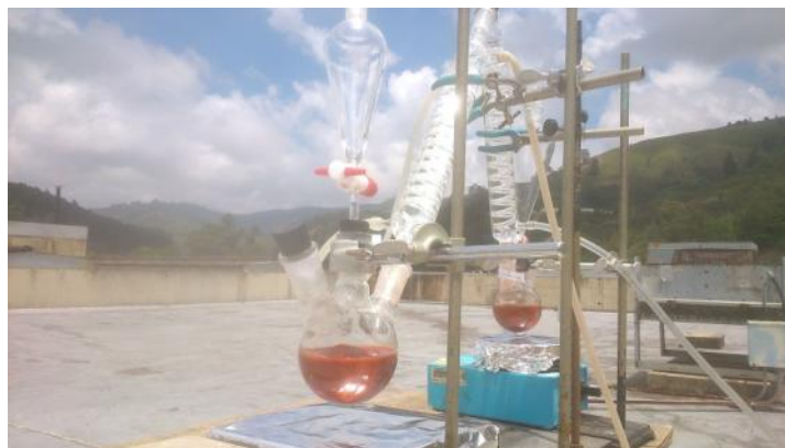
Figura 5.1 Montaje experimental para la fotodegradación de aguas agrias petroleras utilizando lodo rojo CVG-Bauxilum neutralizado y calcinado.
