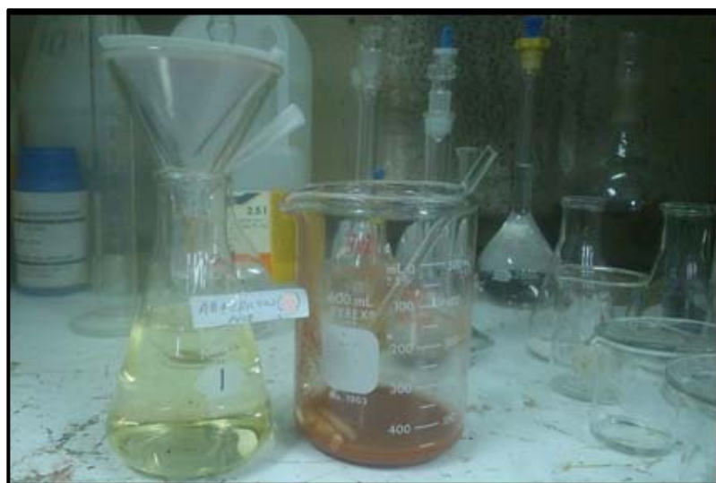
Figura 5.7 Agua agria tratada con procesos de oxidación avanzada utilizando radiación solar y lodo rojo como catalizador
