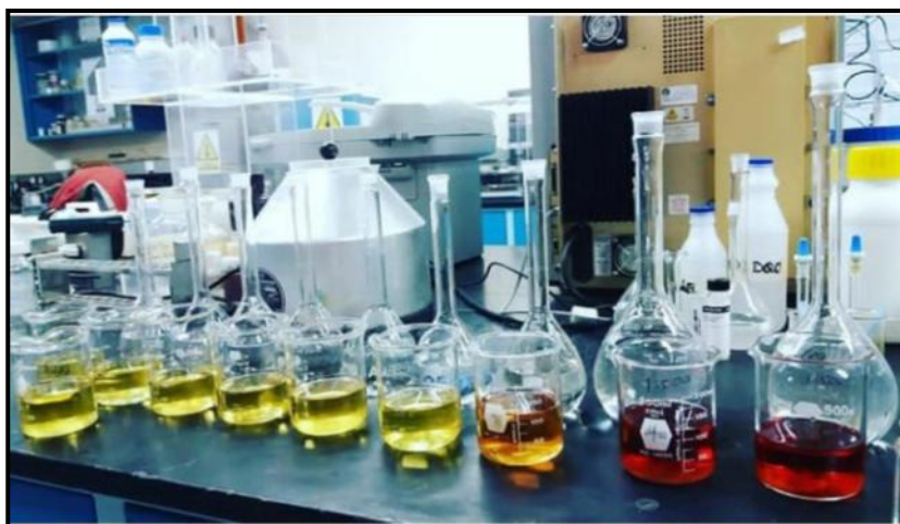
Figura 4.4 Concentración de fenol por el método colorimétrico con 4-aminoantipirina de acuerdo al Standard Methods 5530D.
