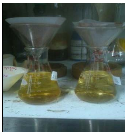
Figura 5.2 Muestra de agua agria del procesamiento de crudos pesados y extrapesados. En el agua agria se determinó una cantidad considerable de sólidos suspendidos y totales, siendo la mayoría de ellos compuestos orgánicos precipitables y azufre (S 8 ), esto a su vez
