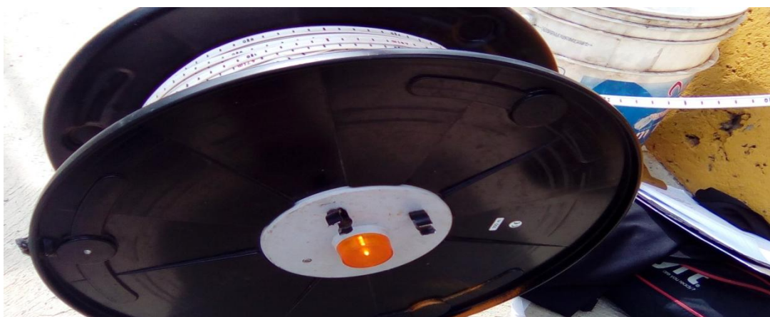
Figura 14. Equipo de Medición Sonda Marca PLM Indicando que se encuentra en contacto con el Nivel Freático, es decir contacto con Agua.
