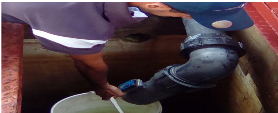
Figura 26. Medición de Caudal Encendido de la Planta Automático Protinal Proagro Planta Embutidos UTM (614668 E; 1126507 N). Elevación: 444 msnm. Fecha: 28/04/2017 Zona Industrial, Municipio San Diego, Estado Carabobo
