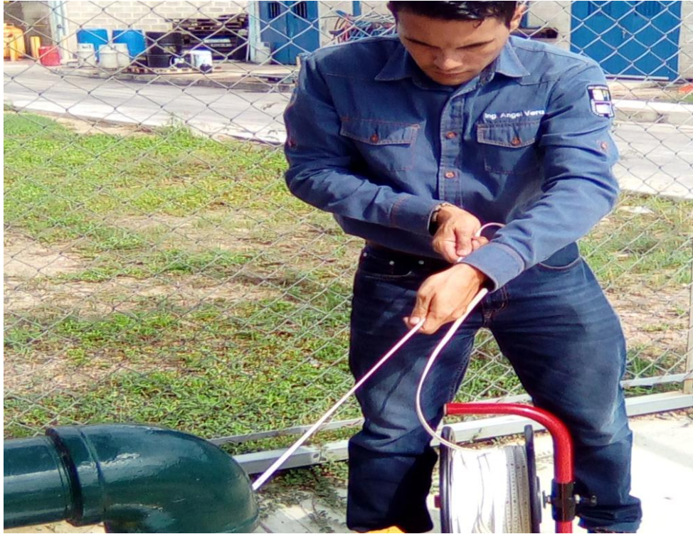
Figura 17. Medición de Nivel Freático, Estado Dinámico Protinal Proagro Planta Embutidos UTM (614668 E; 1126507N). Elevación: 444 msnm. Fecha: 23/03/2017 Zona Industrial, Municipio San Diego, Estado Carabobo
