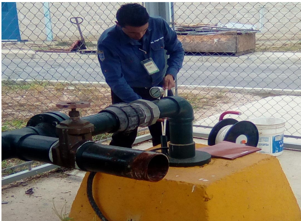
Figura 19. Medición de Nivel Freático, Estado Estático Protinal Proagro Planta Embutidos UTM (614668 E; 1126507 N). Elevación: 444 msnm. Fecha: 30/03/2017 Zona Industrial, Municipio San Diego, Estado Carabobo
