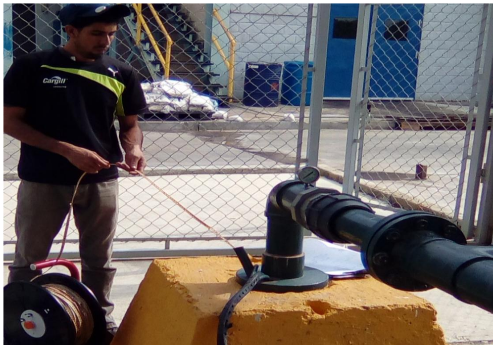
Figura 20. Medición de Nivel Freático, Estado Dinámico Protinal Proagro Planta Embutidos UTM (614668 E; 1126507 N). Elevación: 444 msnm. Fecha: 30/03/2017 Zona Industrial, Municipio San Diego, Estado Carabobo
