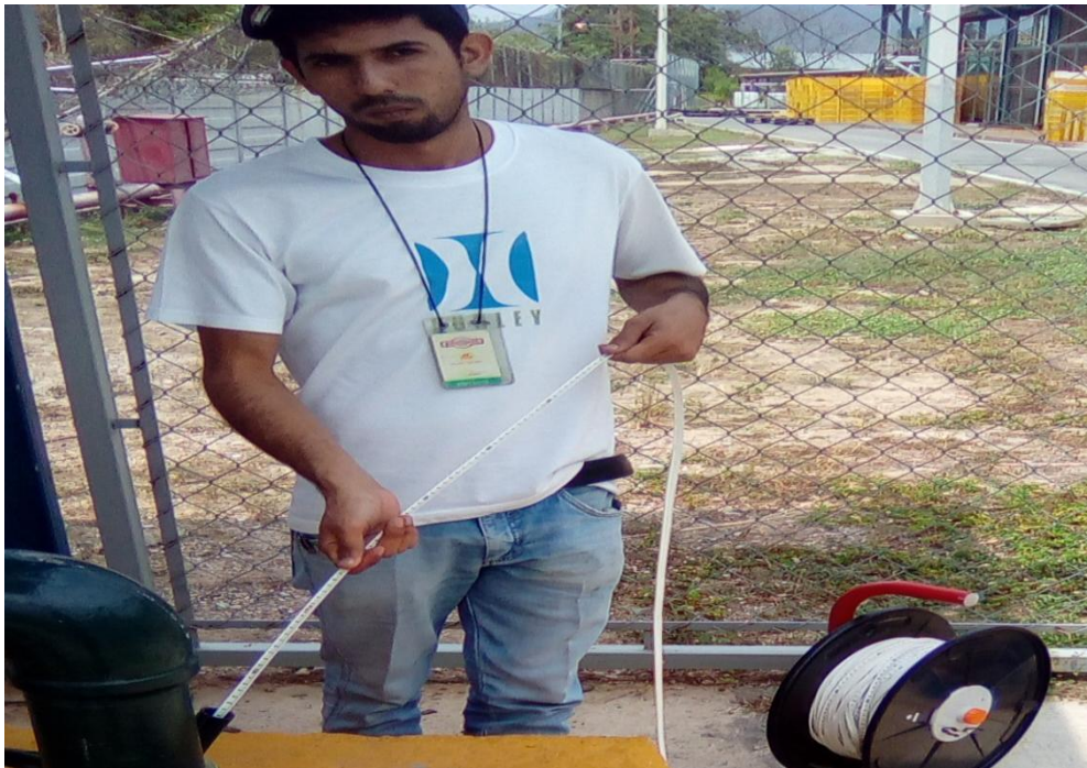
Figura 18. Medición de Nivel Freático, Estado Dinámico Protinal Proagro Planta Embutidos UTM (614668 E; 1126507N). Elevación: 444 msnm. Fecha: 28/03/2017 Zona Industrial, Municipio San Diego, Estado Carabobo
