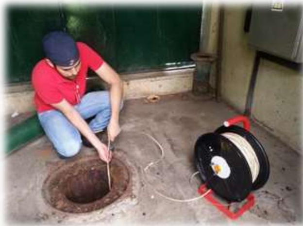
**Figura N° 3. Medición de Niveles en el pozo N°3 de Bigott. Coordenadas UTM 613760E; 1127977N. Zona Industrial Castillito, Municipio San Diego, Estado Carabobo. Fecha: 07/10/2015.**
