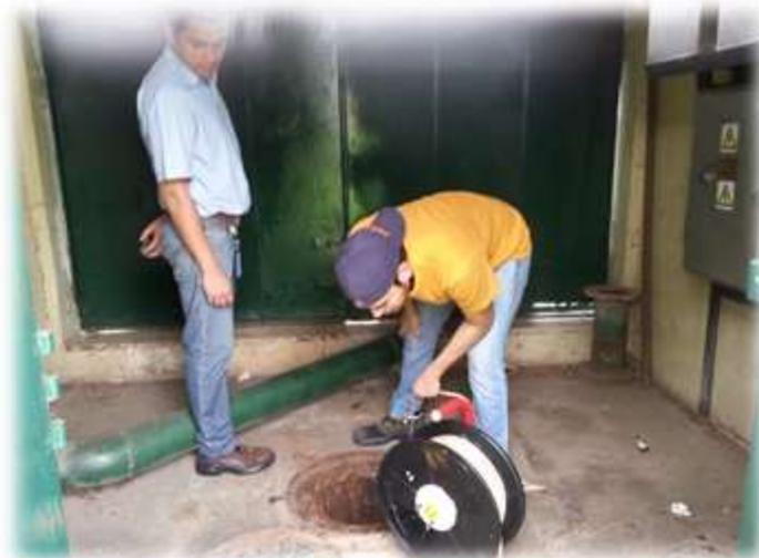
**Figura N° 5. Medición de Niveles en el pozo N°3 de Bigott en compañía del Analista de Ergonomía Higiene y Salud Horang Leo. Coordenadas UTM 613760E; 1127977N. Zona Industrial Castillito, Municipio San Diego, Estado Carabobo. Fecha: 04/11/2015.**
