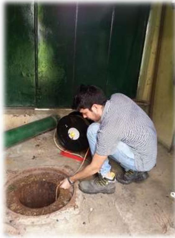
**Figura N° 4. Medición de Niveles en el pozo N°3 de Bigott. Coordenadas UTM 613760E; 1127977N. Zona Industrial Castillito, Municipio San Diego, Estado Carabobo. Fecha: 21/10/2015.**
