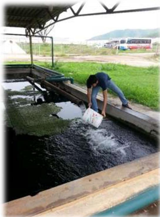
**Figura N° 9. Ejecución de prueba de caudal variable en C.A. Venezolana de Pigmento. Coordenadas UTM 613723.86E; 1127425.32N. Zona Industrial Castillito, Municipio San Diego, Estado Carabobo. Fecha 11/05/2016.**
