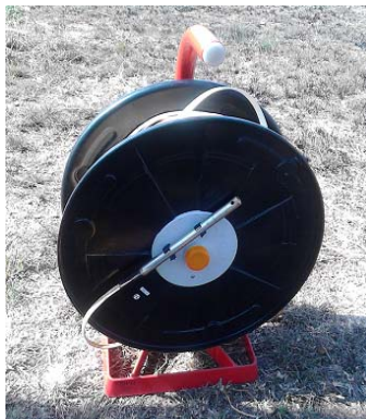
Figura 17: Sonda para medir nivel, modelo PLM, marca Seba Hydrometrie. Fuente: Márquez et al., 2015a,b,c,d,e; 2016a,b,c,2017a,b,c,d,e,f, 2018a,b,c,d,2019a,b; 2021
