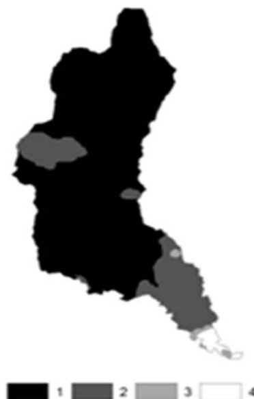
Figura 35: Distribución espacial de la clasificación del agua según diagrama de Piper – Hill – Langelier sobre especies iónicas: 1) Bicarbonato de Ca o Mg, 2) Bicarbonato de Na, 3) Sulfato o Cloruro de Ca o de Mg, 4) Sulfato o Cloruro de Na. (tomado de Márquez, 2018)
