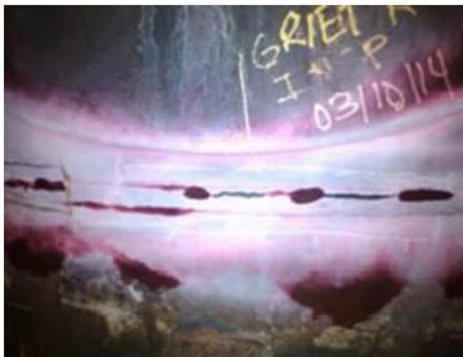
Figura N° 47.-Resultado de ensayo de líquidos penetrantes en tubería.
