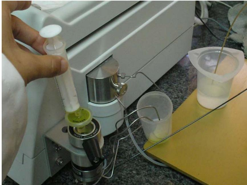
**Fig. 15:** Colocación de la muestra en el cromatógrafo líquido HPLC
