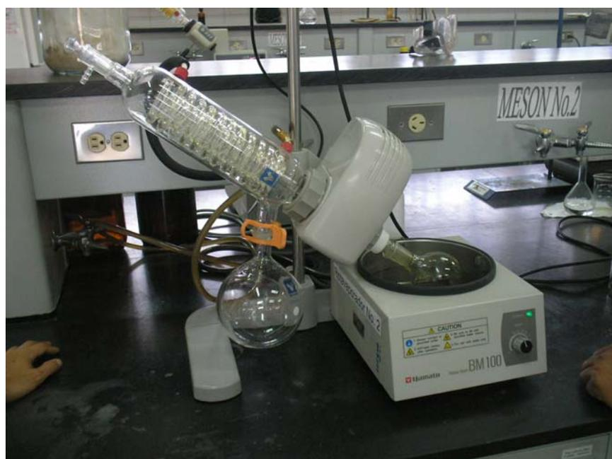
**Fig. 9:** Destilación de la fase orgánica en el Rotaevaporador
