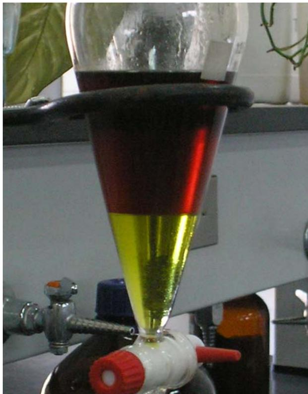
**Fig. 7:** Embudo de separación: Fase orgánica y fase acuosa del aceite
