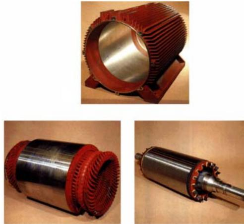
**Figura 4.1** Carcasa, estator y rotor de un motor eléctrico
